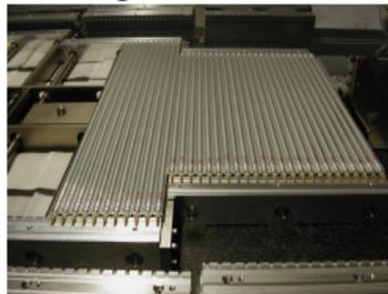
Kleben der zweiten Rohrlage
