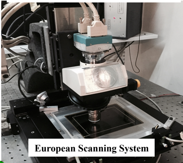
LNGS: 12 microscopes, 240 cm 2 /h
