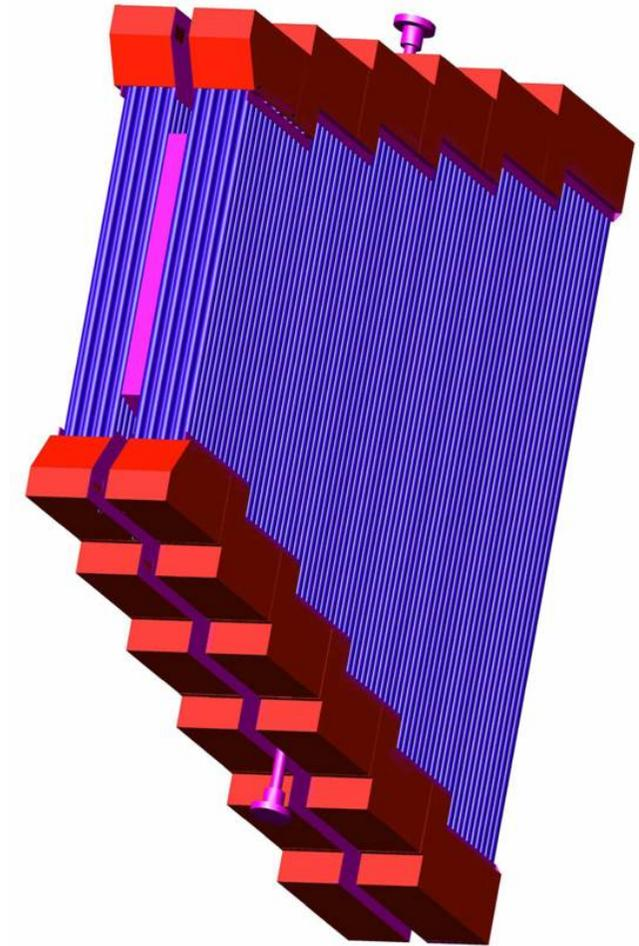
Eine Kammer besteht aus zwei Multilagen mit je 8 Lagen 15 mm Rohren. Der stufenförmige Aufbau ergibt sich aus der Position im Myonenspektrometer.
