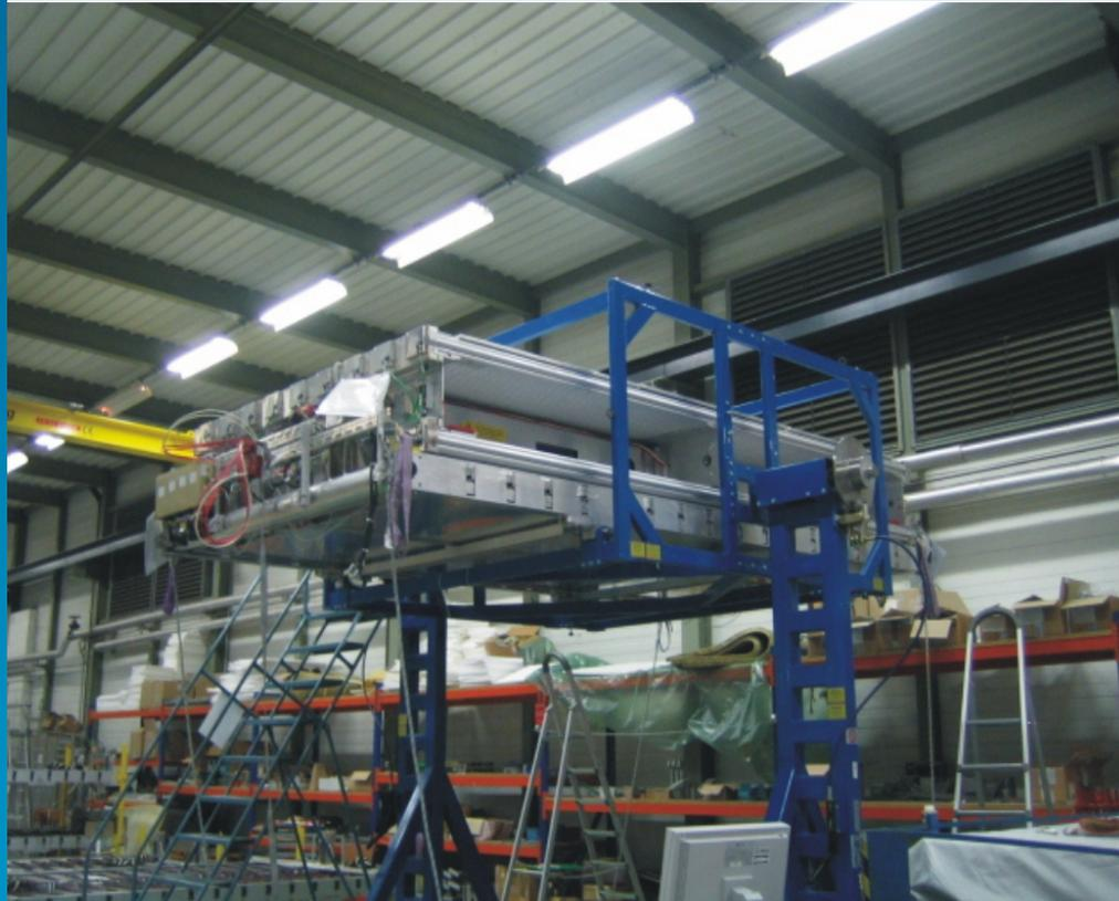
*Die MDT Station wird in den zu erwartenden Installationswinkel geschwenkt und in dieser Position neu vermessen*
