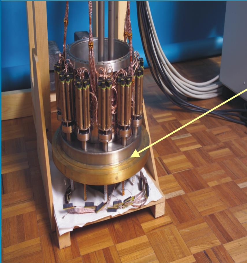
*die technologische Herausforderung (kaltfeste und vakuumdichte Hartverlötung eines Messingflansches mit einem Edelstahlrohr) der Fertigung eines neuen Hut Flansches für das Projekt CRESST, wurde erfolgreich gemeistert, die Verbindung war auf Anrieb dicht*
