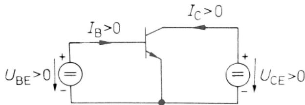
Wenn man  $U_{BE}$  erhöht, verringert man die Spannung zwischen Basis und Kollektor, wodurch die Diode BC leitender wird und somit mehr Strom aus dem Emitter fließt, als in die Basis geflossen ist.
