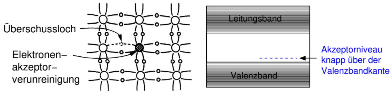
⇒ Erhöhte Leitfähigkeit durch Überschusslöcher, die entstehen, wenn Elektronen aus dem Valenzband ins Akzeptorniveau angehoben werden.
