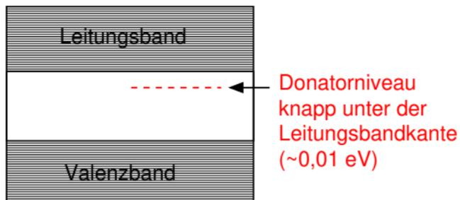
⇒ Erhöhte Leitfähigkeit durch Überschusselektronen, die sehr leicht thermisch vom Donatorniveau ins Leitungsband angeregt werden können.
