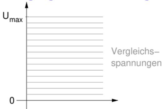
Unterteilung des dynamischen Bereichs des Analog-Digital-Wandlers in eine Reihe Vergleichsspannungen.
